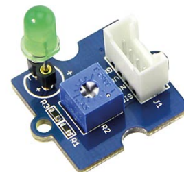
Led verte branchée sur D3
