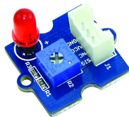
Led rouge branchée sur D2
